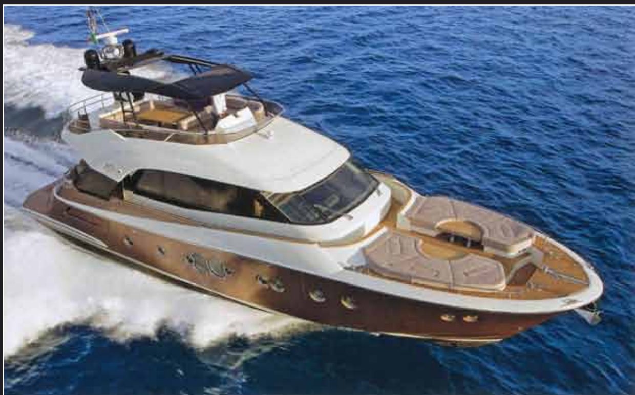
Pod-Antrieb und acht Zylinder; Der 21,30 Meter lange Flybridge-Flitzer erreicht bis zu 33 Knoten und reist mit 28 Knoten.
